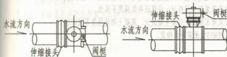
立式蝶阀安装平面示意图
